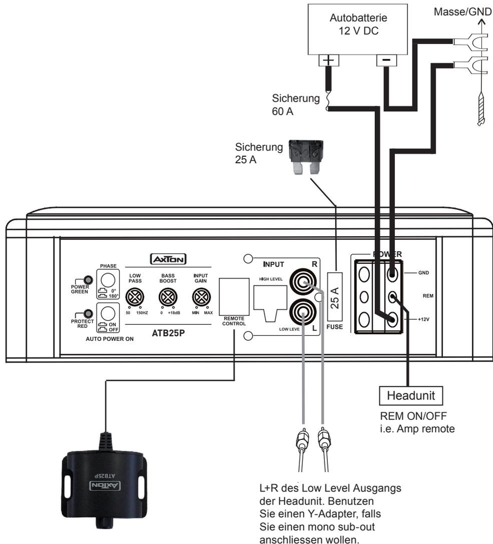
Montieren Sie den Bass Boost Regler an einer leicht erreichbaren Stelle.
