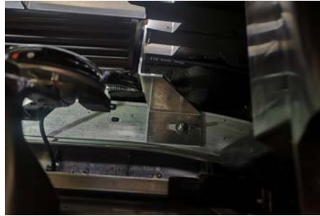
Høyre og venstre feste monteres på bjelken, med en bolt montert nedenfra.
