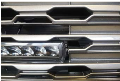
Monter deretter LED-baren fast i høyre og venstre feste.
